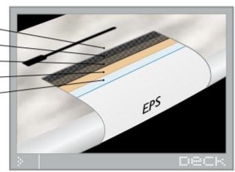
Technologie Sandwich 100% Carbone + Finition Ponçée Ultra Légère
