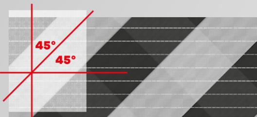
Fibres de Carbone Innegra Biax à 45/45 degrés, avec sur le dessus une couche supplémentaire de fibres au tissage à 90 degrés. Cette association de fibres judicieusement placées répond idéalement à un bon équilibre entre flexion et rigidité.
