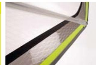
Un gallon PVC protège la bordure de voile contre l'abrasion du flotteur
