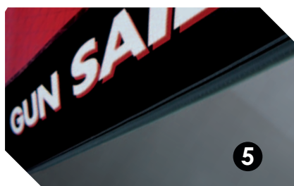
FOOT GUARD Un gallon profilé en PVC apposé sur la bordure de la voile du point d'amure au point d'écoute protège de l'abrasion provoquée par le flotteur.
