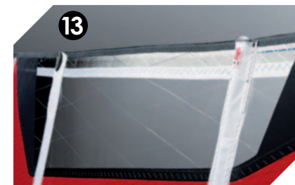
SYMMETRICAL BATTEN SYSTEM Les voiles sans camber sont équipées d'une latte positionnée à l'opposé des autres lattes. Cela permet d'équilibrer l'asymétrie générée par le positionnement des autres lattes sur un seul bord.
